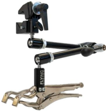
L'OPG est un outil de positionnement de la source radioactive conçu pour faciliter les contrôles par radiographie industrielle ou gammagraphie industrielle dans le domaine du Contrôle Non Destructif (CND).
