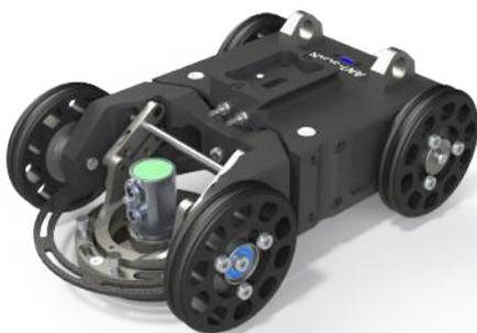
Le RUC1 est un Runner déployable par perche ou manuellement, destiné au contrôle par ultrasons de type A-Scan / B-Scan.
