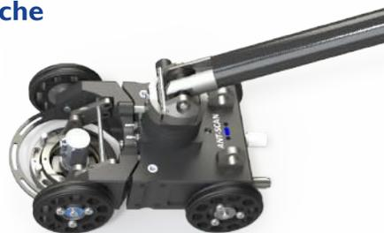
Grâce à sa perche en fibre de carbone, le RUC1 peut être déployé en hauteur jusqu'à 10m, permettant de réaliser des contrôles sur des zones d'accès difficile en limitant les risques et en réduisant les coûts des moyens traditionnels (Cordistes, échafaudages, robots complexes ...)
